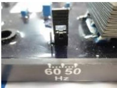
Figura 16.2: Jumper en 50 Hz
