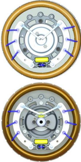
Figura 10.5: Vista frontal del rotor de la excitatriz GTA / AG10
