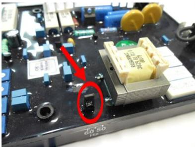
Figura 16.1: Jumper de frecuencia
