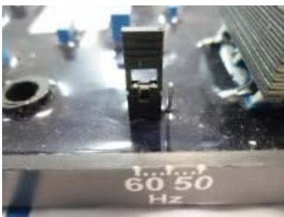
Figura 16.3: Jumper en 60 Hz
