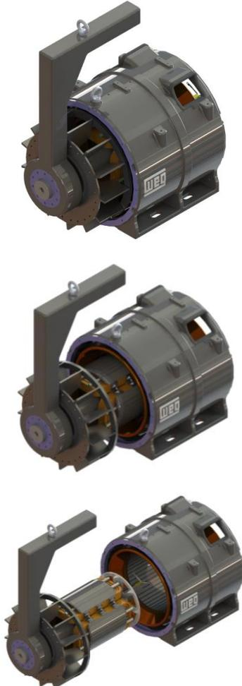
Figura 10.6: Remoción del rotor principal con el dispositivo péndulo
