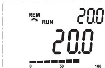
Abbildung 13.3: Beispiel für die HMI im Überwachungsmodus für den Gebrauch des PID-Reglers
