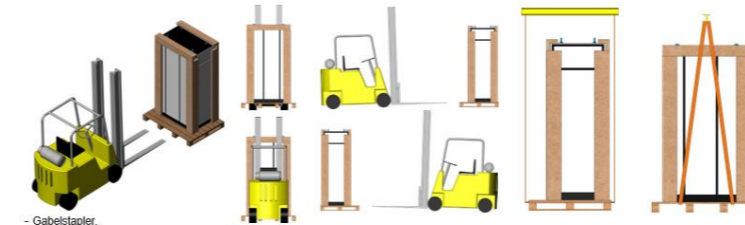
Abbildung 4.3: Vorgehensweise beim Transport mit Gabelstapler oder Hebezeug
