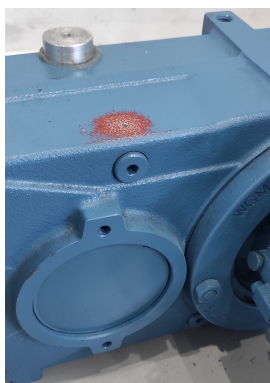
(a) Remoción de pintura
