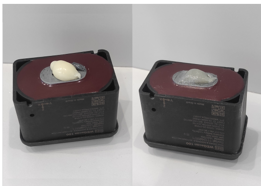
(a) Aplicación de adhesivo en la base del sensor
