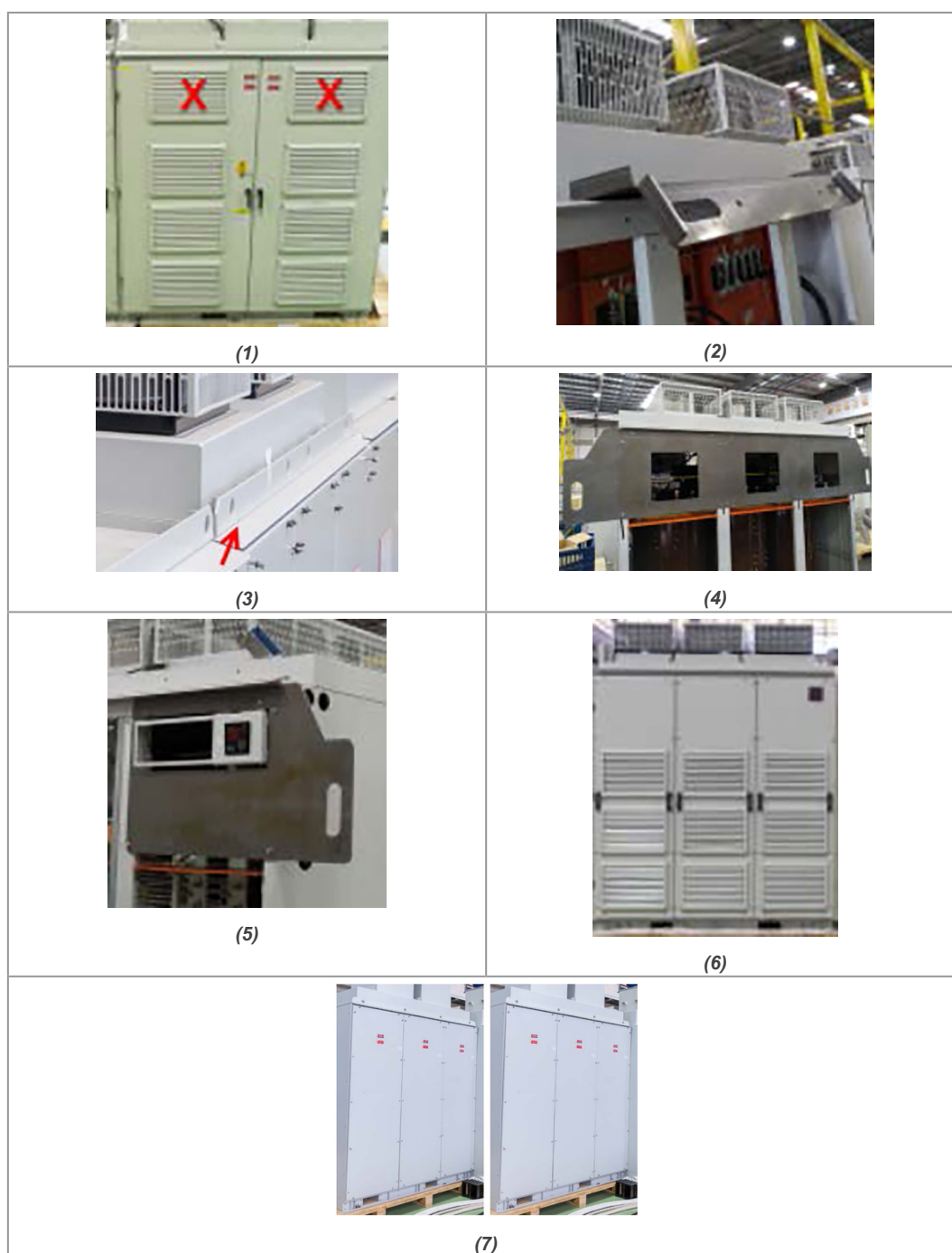
Figura 6.4: Procedimento de remoção dos reforços de transporte aéreo do MVW3000
