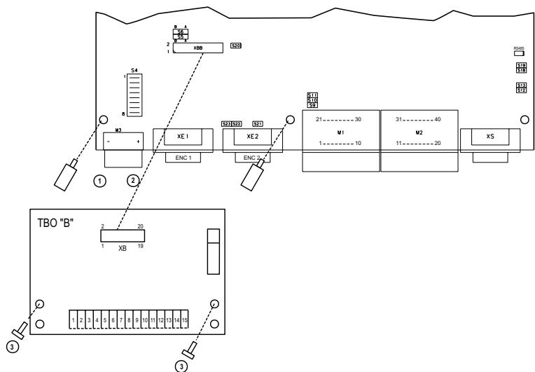
La scheda TBO viene fornita con un kit per il fissaggio alla scheda di regolazione.
