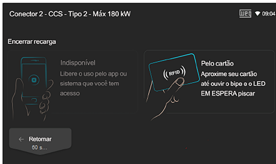
Figura 7.14: Tela de finalização da recarga via cartão RFID
