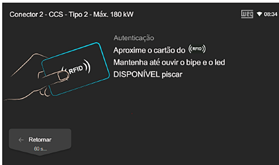
Figura 7.7: Tela com instruções para liberação da recarga via RFID
