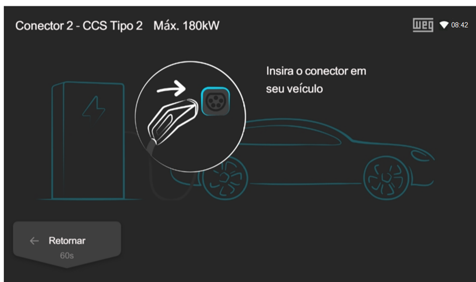
Figura 7.10: Tela de instrução para “Inserir o conector em seu veículo”
