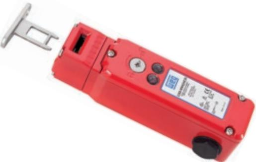
criando uma chave de intertravamento de operação positiva que não pode ser facilmente burlada. Quando a proteção é fechada e o atuador é inserido na chave, os contatos de segurança fecham, o atuador é travado e o circuito de partida da máquina pode ser habilitado. Quando a solenoide é energizada, os contatos de segurança abrem de forma positiva, o circuito de parada da máquina é interrompido e a porta de proteção pode ser aberta.
