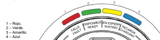
Figura 6.1: LEDS de señalización
