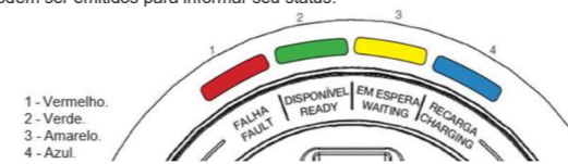
Figura 6.1: LEDS de sinalização
