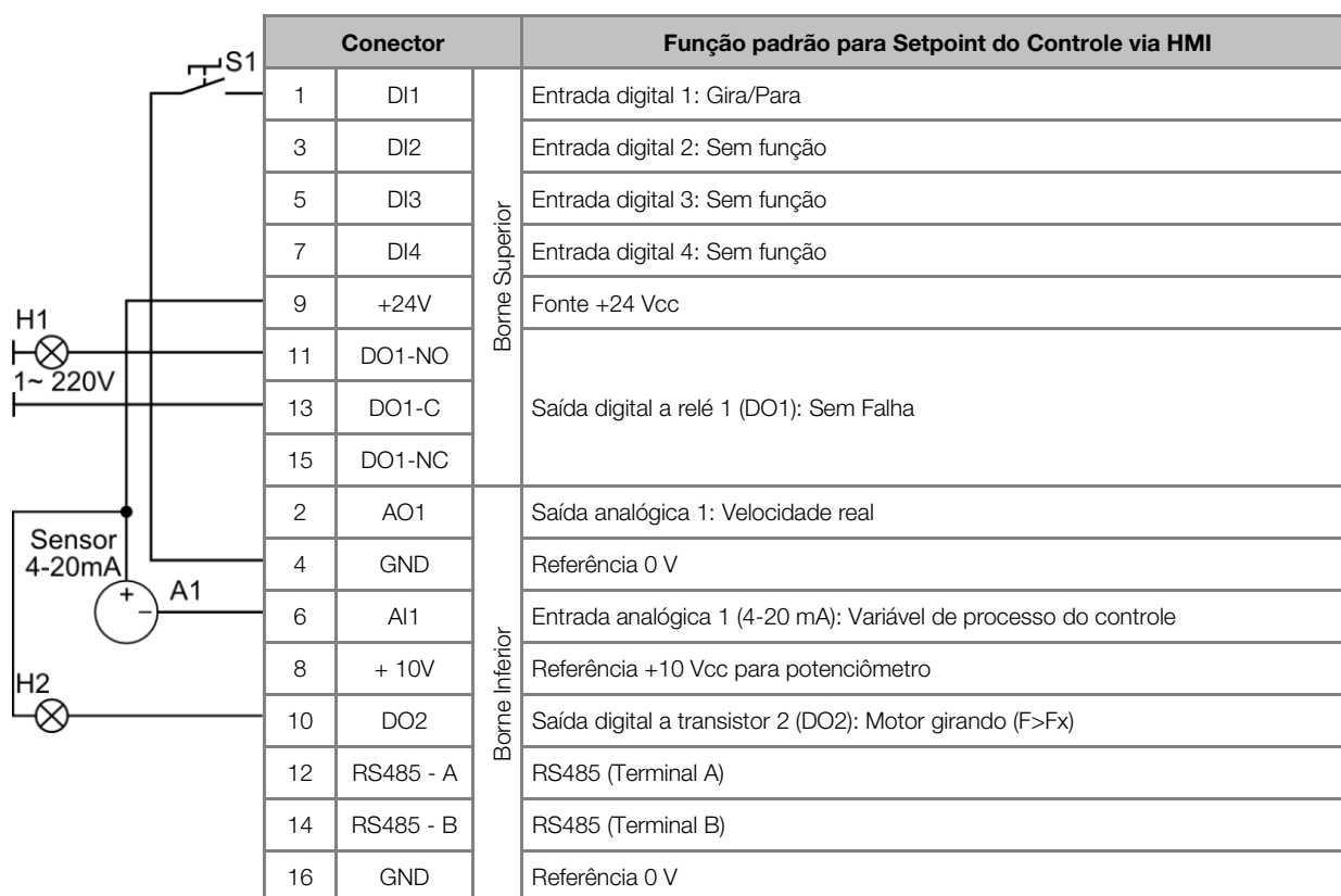
Figura 2.2 – Sinais no conector do módulo plug-in CFW500-IOS para setpoint do controle via HMI
