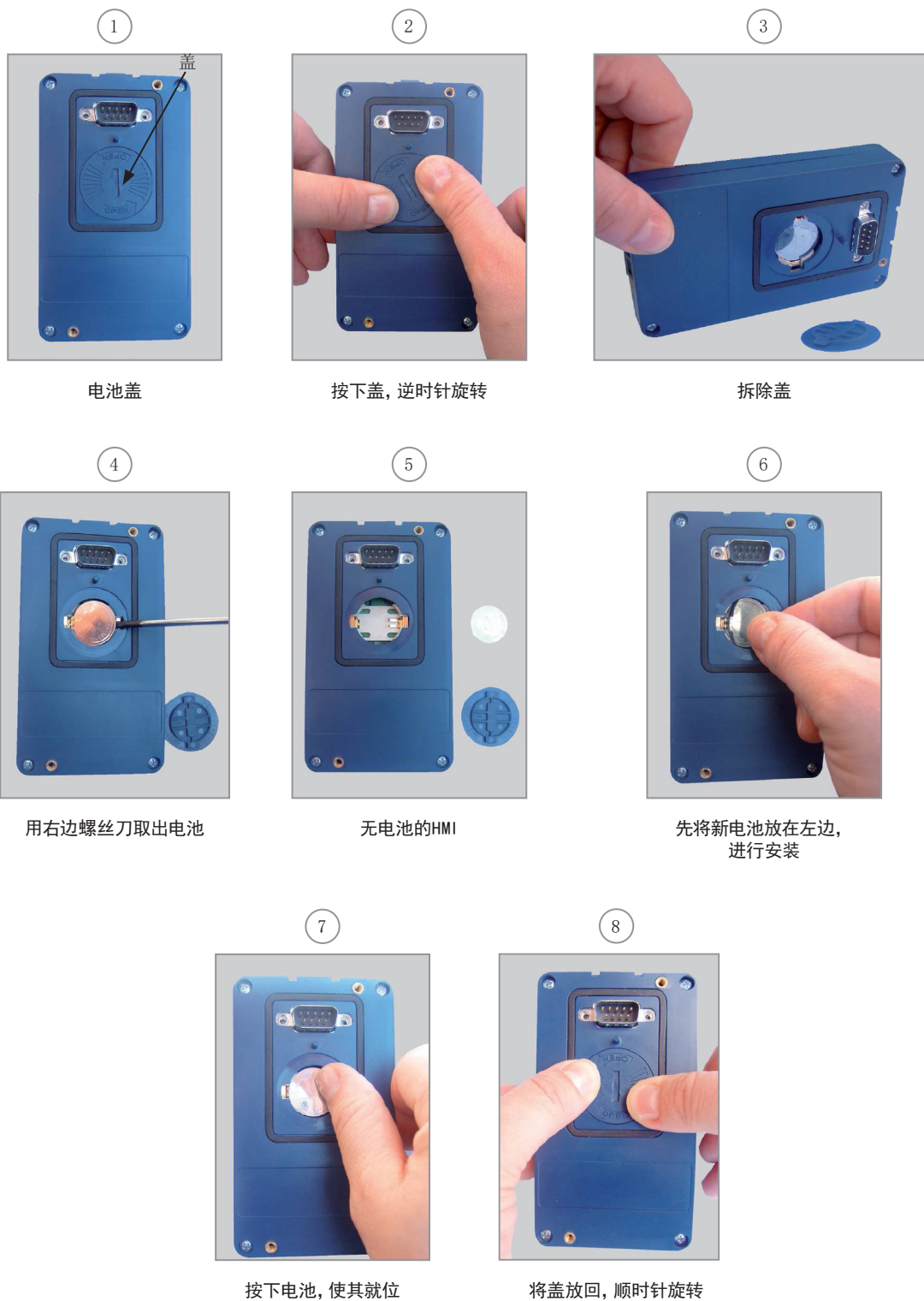
图 4.4：更换HMI电池
