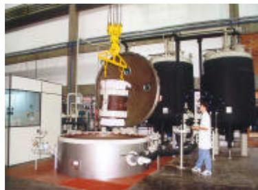
a intempéries. As resinas epóxi são ideais para impregnações porque após a cura apresentam excelente resistência a intempéries que são encontradas nos
