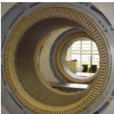
**Estator bobinado** - É constituído de partes magnéticas estacionárias, incluindo o pacote laminado de chapas de aço silício e o enrolamento do estator, que opera com alimentação de potência em corrente alternada para gerar o campo magnético girante.
