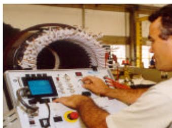
**Impregnação** - Após a inserção das bobinas, fechamento das ranhuras, conexões e amarrações das cabeças das bobinas, o estator bobinado é impregnado a vácuo e pressão utilizando-se resina epóxi classe H isenta de solventes, que garante ao sistema de isolamento WEG excelentes propriedades elétricas, mecânicas e resistência
