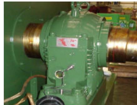
Quando o rotor gira, o óleo lubrificante é recolhido pelo anel pescador interno e transferido diretamente à superfície do eixo criando uma camada de óleo entre o eixo a superfície dos casquilhos do mancal.
