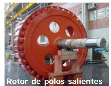
Após bobinados e impregnados, os pólos são fixados ao eixo ou a roda polar, através de parafusos, por cima ou por baixo do pólo, ou conectados por meio de rabo de andorinha.
