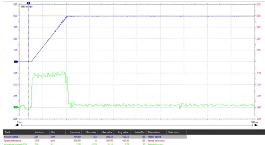
Figura 5-9: Valore di Speed reg P troppo alto, oscillazioni della corrente di armatura e della velocità
