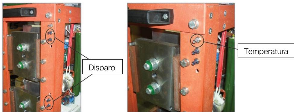
Figura 5.20: Conexiones de las fibras ópticas de disparo y de la temperatura
