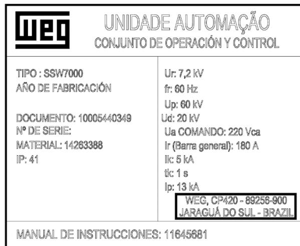
Figura 3.9. Etiqueta de identificación del SSW7000.
