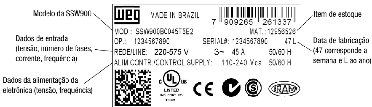
Figura 2.3: Etiqueta de identificação na lateral da SSW900
