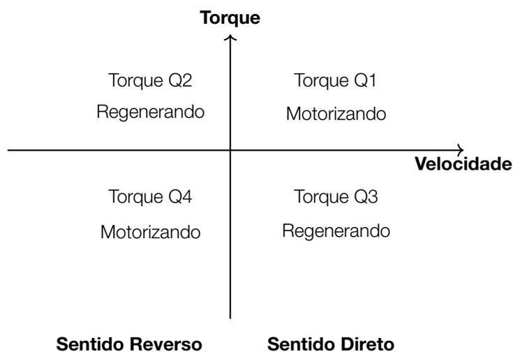
**Figura 11.12:** Convenção dos limitadores de torque do motor nos quatro quadrantes de operação do motor
