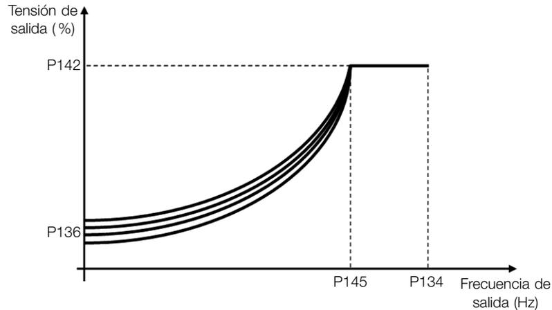
**Figura 8.16:** Región del boost de torque para modo del control V/f Cuadrático
