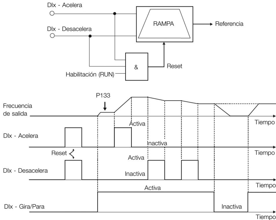
Figura 9.13: Ejemplo de la función Potenciómetro Electrónico (E.P.)
