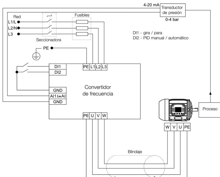
Figura 14.2: Ejemplo de la aplicación controlador PID
