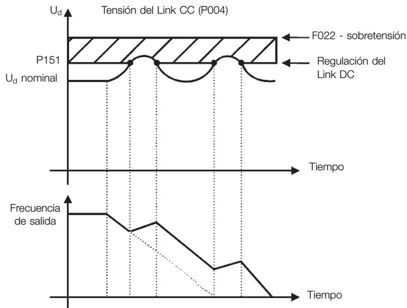
**Figura 8.5:** Gráfico ejemplo de la limitación de la tensión del Link DC - Acelera Rampa ( $P150 = 0$  o  $1$ )
