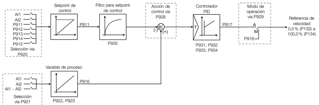
*Figura 14.1: Diagrama de bloques del controlador PID*
