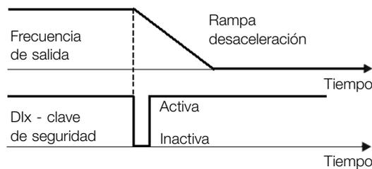
Figura 9.18: Ejemplo de la función Emergencia
