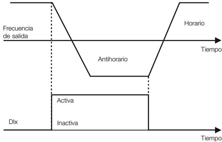
Figura 9.11: Ejemplo de la función Sentido de Giro
