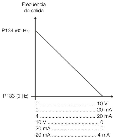
Para AI1 parametrizada con 10-0 V (P233=2) y la señal de entrada en 7,5 V tenemos:
