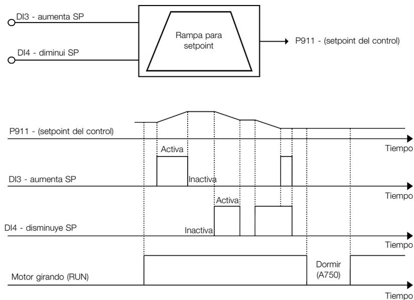
**Figura 14.3:** Gráfico de funcionamiento de la función E.P.
