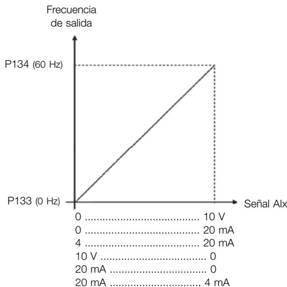
Para AI1 parametrizada con 0-10 V (P233=0) y la señal de entrada en 5 V tenemos:
