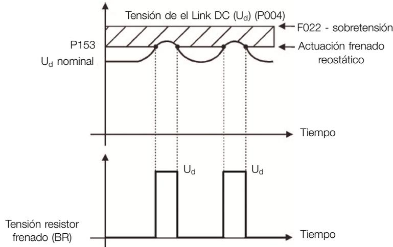
Figura 8.10: Curva de actuación del frenado reostático
