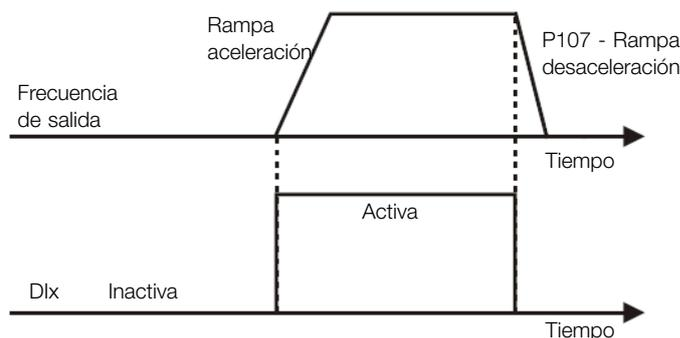
Figura 9.8: Ejemplo de la función Parada Rápida
