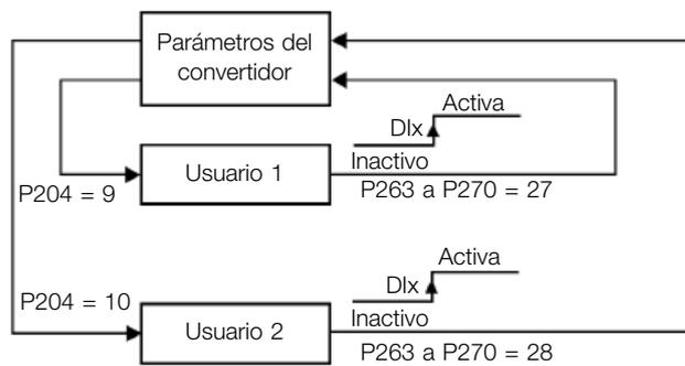
Figura 9.15: El diagrama de bloques de funciones carga al usuario 1 y al usuario 2
