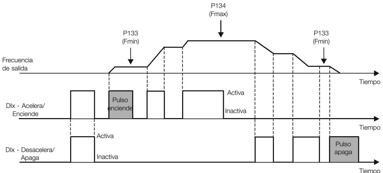
Figura 9.16: Ejemplo de la función Acelera-Enciende / Desacelera-Apaga
