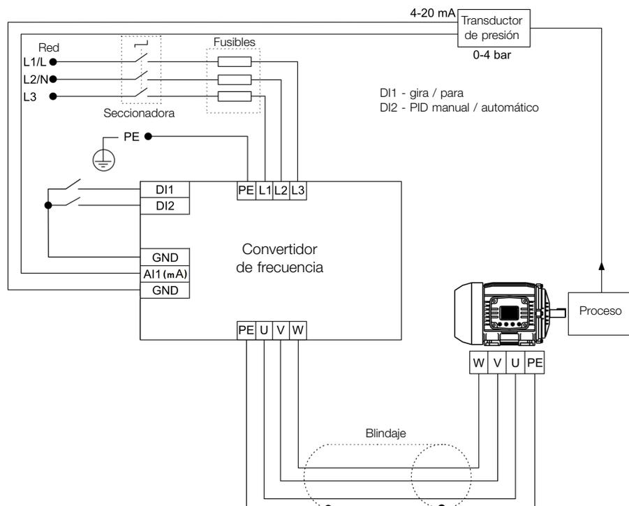
**Figura 15.7:** Ejemplo de la aplicación controlador PID
