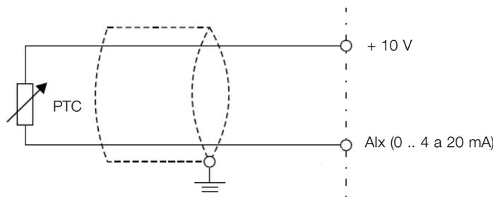
**Figura 10.1:** Conexión del PTC al convertidor frecuencia
