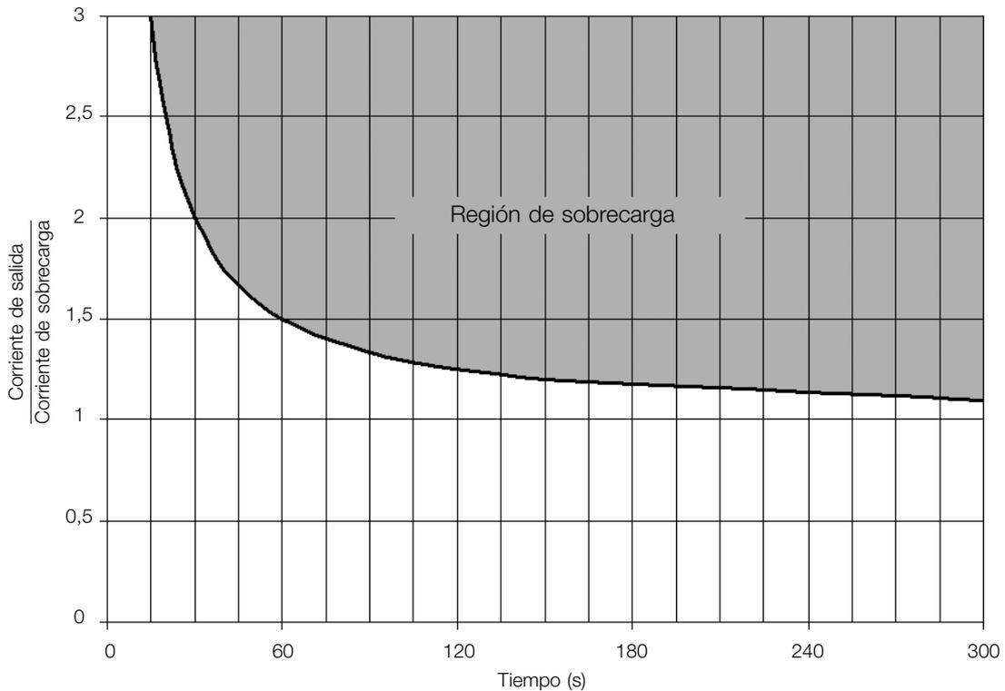
**Figura 10.2:** Actuación de la sobrecarga del motor
