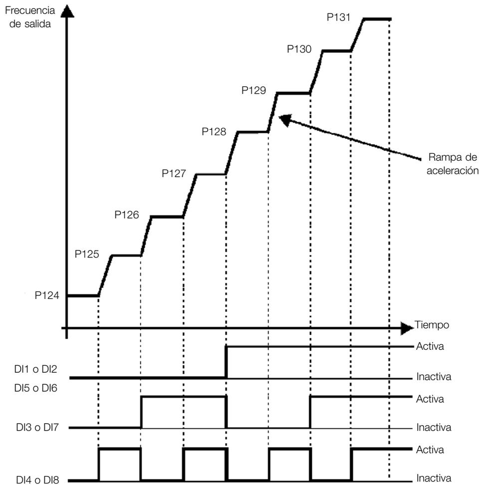
**Figura 7.3:** Gráfico de funcionamiento de la función Multispeed
