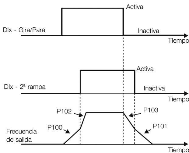
Figura 9.14: Ejemplo de la función 2ª Rampa
