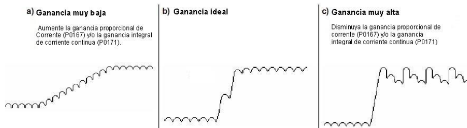
Figura 6.4 – Salidas posibles para la medición de la señal “IA” en el ajuste del regulador de corriente.
