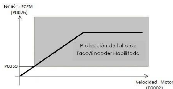
Figura 7.17 – Región de monitoreo de la protección de Falta de Taco/Encoder de acuerdo con el valor de P0353.
