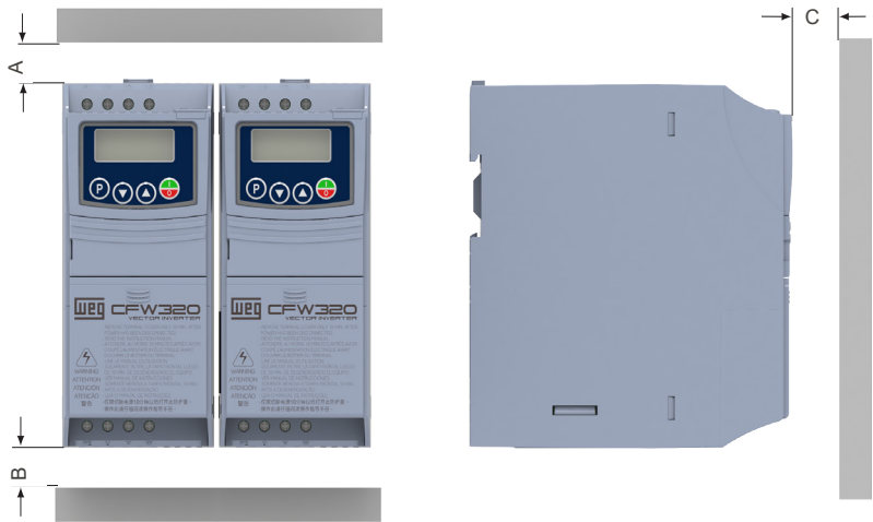
(d) Minimum ventilation free spaces (d) Espacios libres mínimos para ventilación (d) Espaços livres mínimos para ventilação (d) 最小无通风空间
