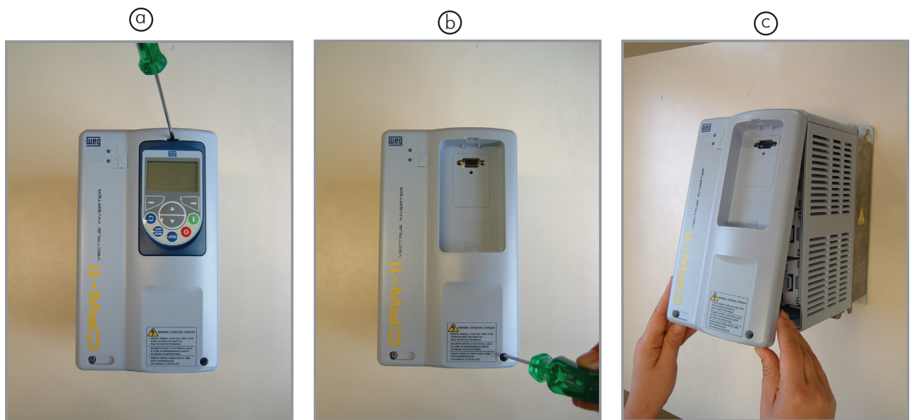
Figure 2: Démontage du couvercle frontal
