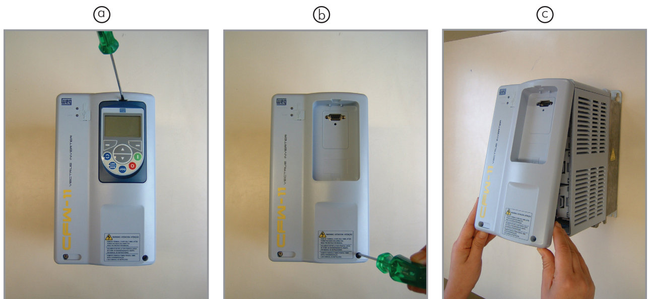
Bild 2: Abnehmen der Vorderabdeckung
