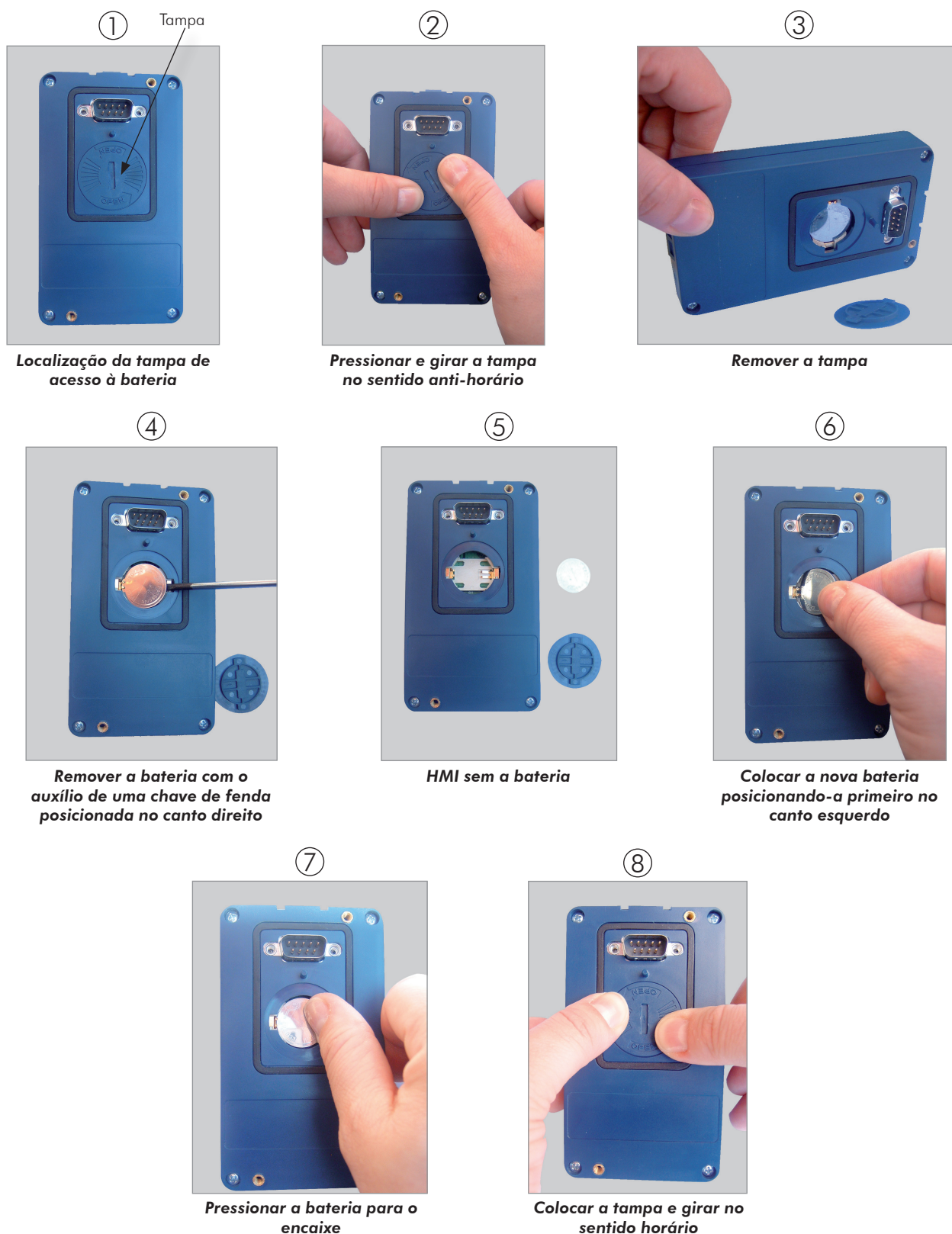
Figura 4.2 - Substituição da bateria da HMI
