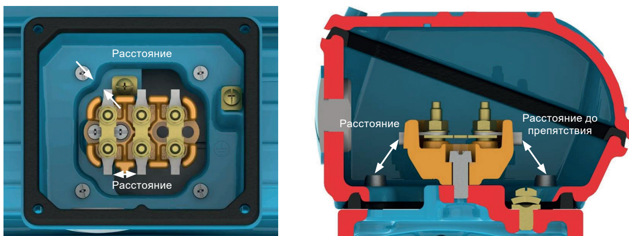
Рисунок 6.16: Минимальное расстояние (мм) x напряжение питания
