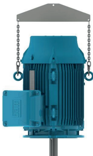
Рисунок 4.8: Подъем вертикально установленных двигателей
