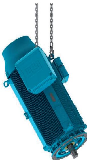
Рисунок 4.17: Подъем двигателей HGF, W50 и W51 HD с помощью рым-болтов на не приводном конце
