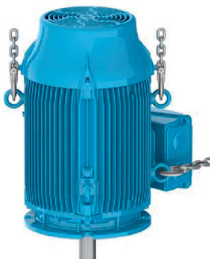
Рисунок 4.12: Конечный результат: двигатель установлен в вертикальном положении
