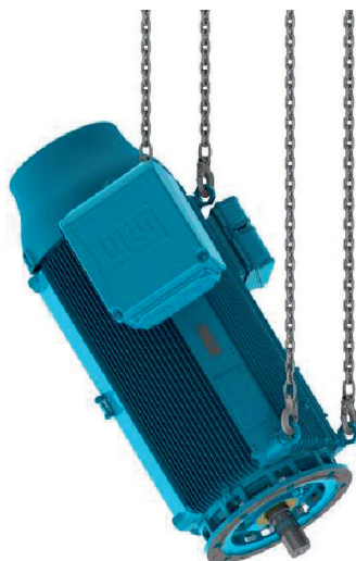
Рисунок 4.16: Установка двигателей HGF, W50 и W51 HD в вертикальное положение
