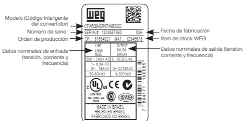
Figura 1: Descripción de las etiquetas de identificación en el CFW500
