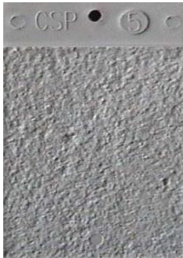
Figura 11 - Referência da preparação de superfície, conforme Padrão CSP 5 Fonte: NACE (2018)
