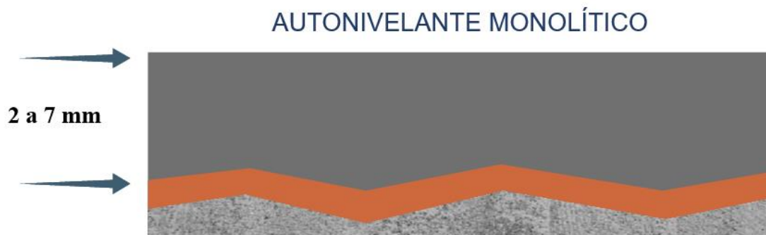
Figura 38 - Piso autonivelante Fonte: Treinamento WEG (2020)
