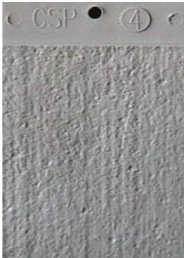
Figura 13 - Referência da preparação de superfície, conforme Padrão CSP 4 Fonte: NACE (2018)
