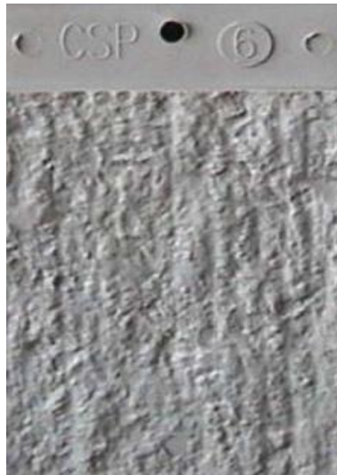
Figura 14 - Referência da preparação de superfície, conforme Padrão CSP 6 Fonte: NACE (2018)
