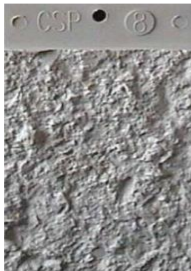
Figura 16 - Referência da preparação de superfície, conforme Padrão CSP 8 Fonte: NACE (2018)
