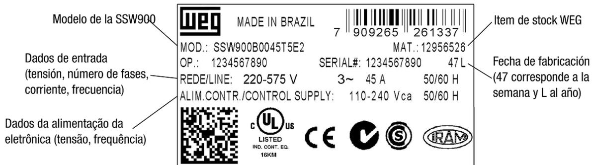
Figura 2.3: Etiqueta de identificación en la lateral del SSW900
