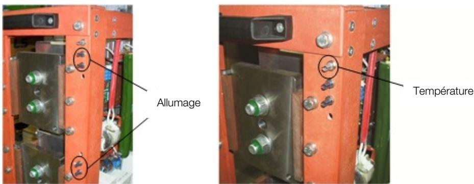
Figure 5.20: Raccordements des câbles à fibres optiques d'allumage et de mesure de la température
