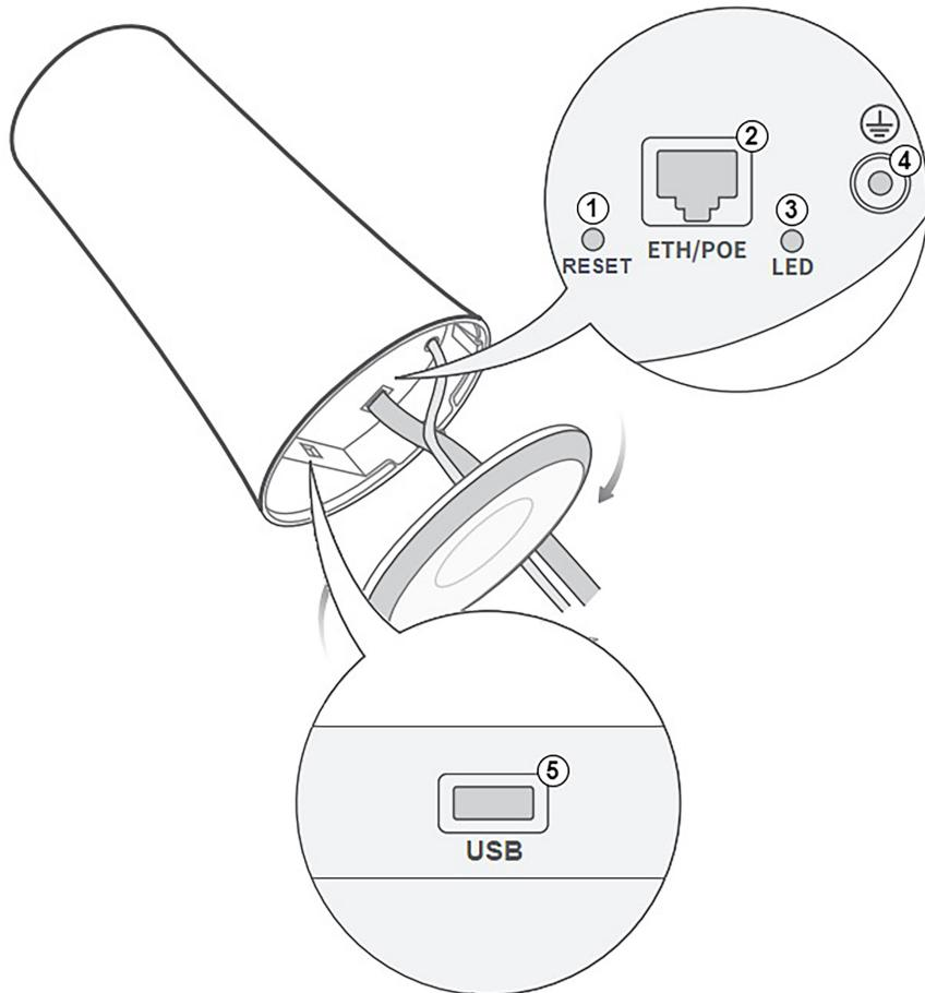
*Figura 4.3: Imagen del gateway Cassia X1000 con indicación de los conectores y puertos*
