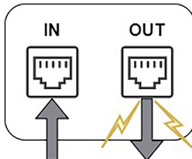
*Figura 4.8: Imagem ilustrativa dos conectores RJ45 do carregador incluso no produto Cassia X1000*
