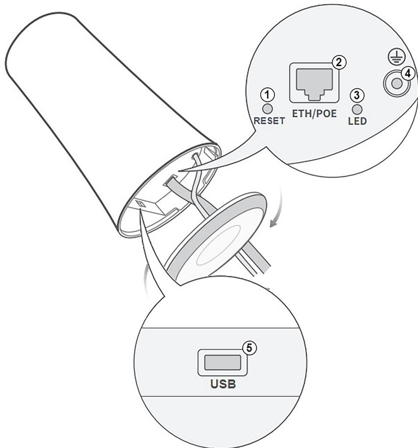
*Figura 4.3: Imagem do gateway Cassia X1000 com indicação dos conectores e portas*
