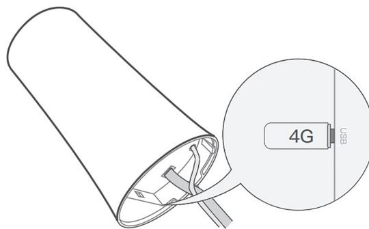
Figura 4.10: Cassia X1000 insertando el dongle 3G/4G
