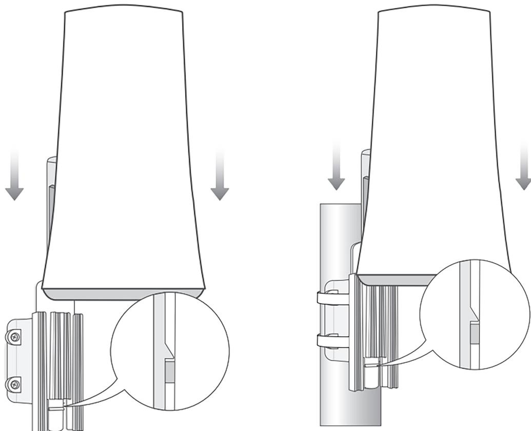
Figura 4.14: Cassia X1000 siendo encajado en el soporte en pared y poste, respectivamente
