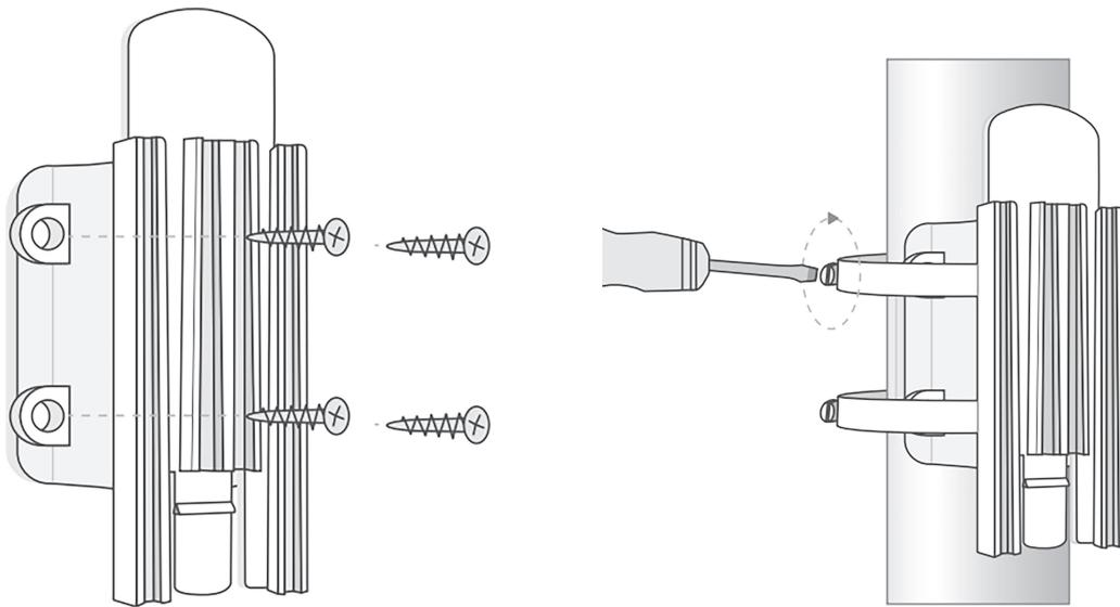
**Figura 4.13:** Suporte do Cassia X1000 sendo instalado em parede e poste, respectivamente
