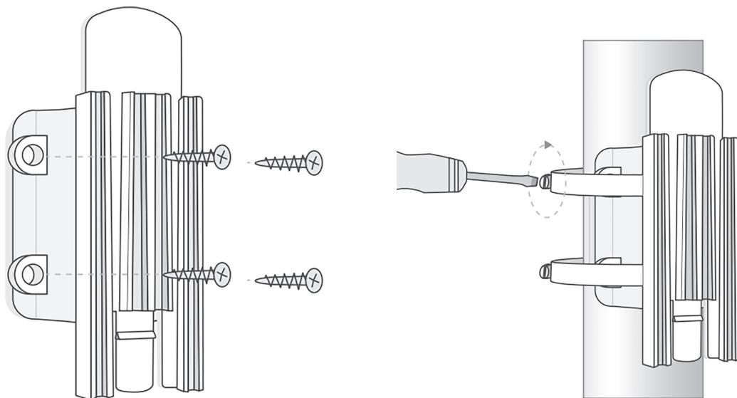
Figura 4.13: Soporte del Cassia X1000 siendo instalado en pared y poste, respectivamente
