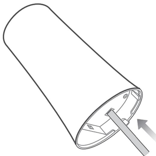
Figura 4.7: Cassia X1000 inserindo cabo ethernet
