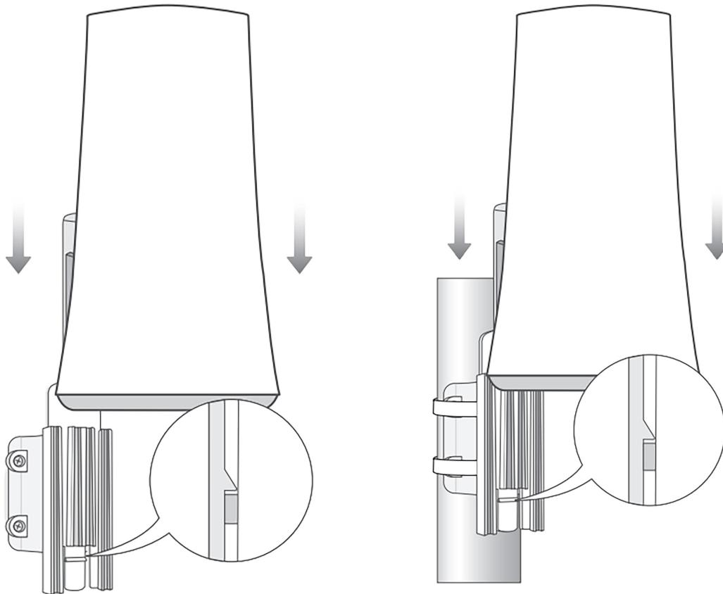
*Figura 4.14:* Cassia X1000 sendo encaixado no suporte em parede e poste, respectivamente
