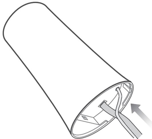
Figura 4.9: Cassia X1000 insertando el cable de puesta a tierra
