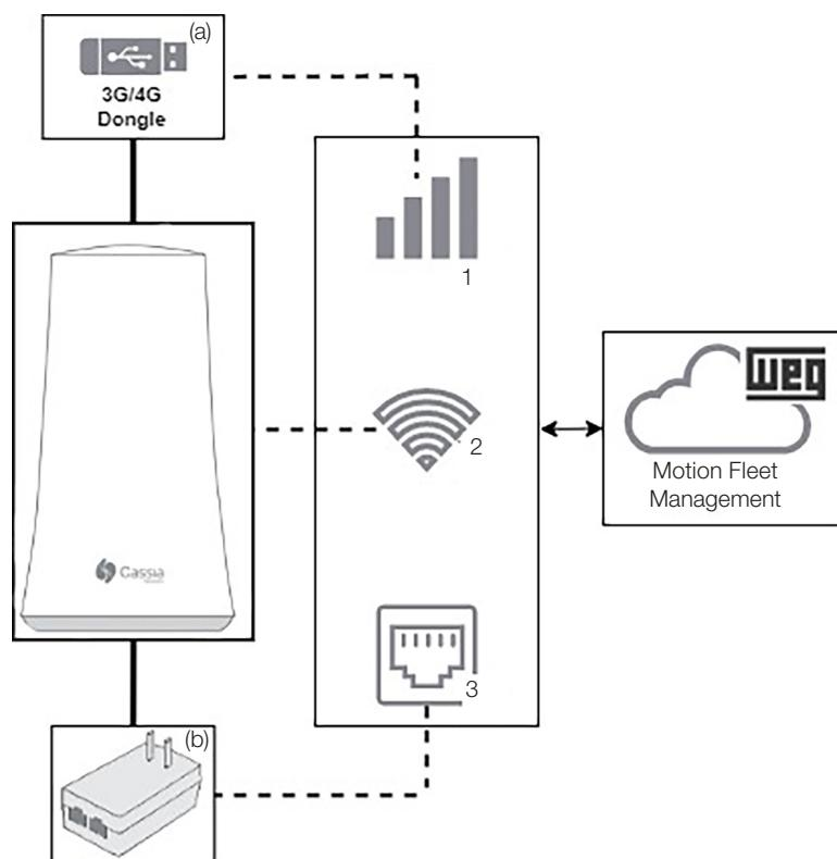
*Figura 4.4: Diagrama de las opciones de conexión a internet para el gateway Cassia X1000*
