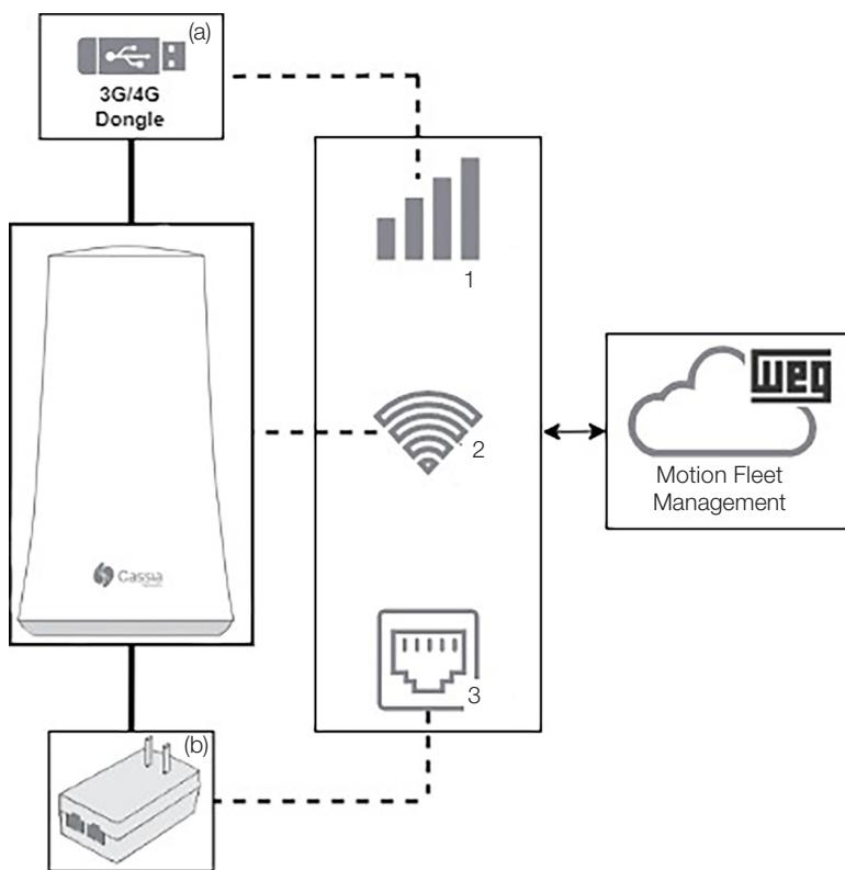
*Figura 4.4: Diagrama das opções de conexão à internet para o gateway Cassia X1000*
