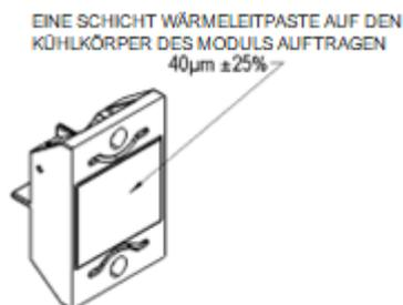
Abbildung 6.4: Auftragen von Wärmeleitpaste auf das Diodenmodul
