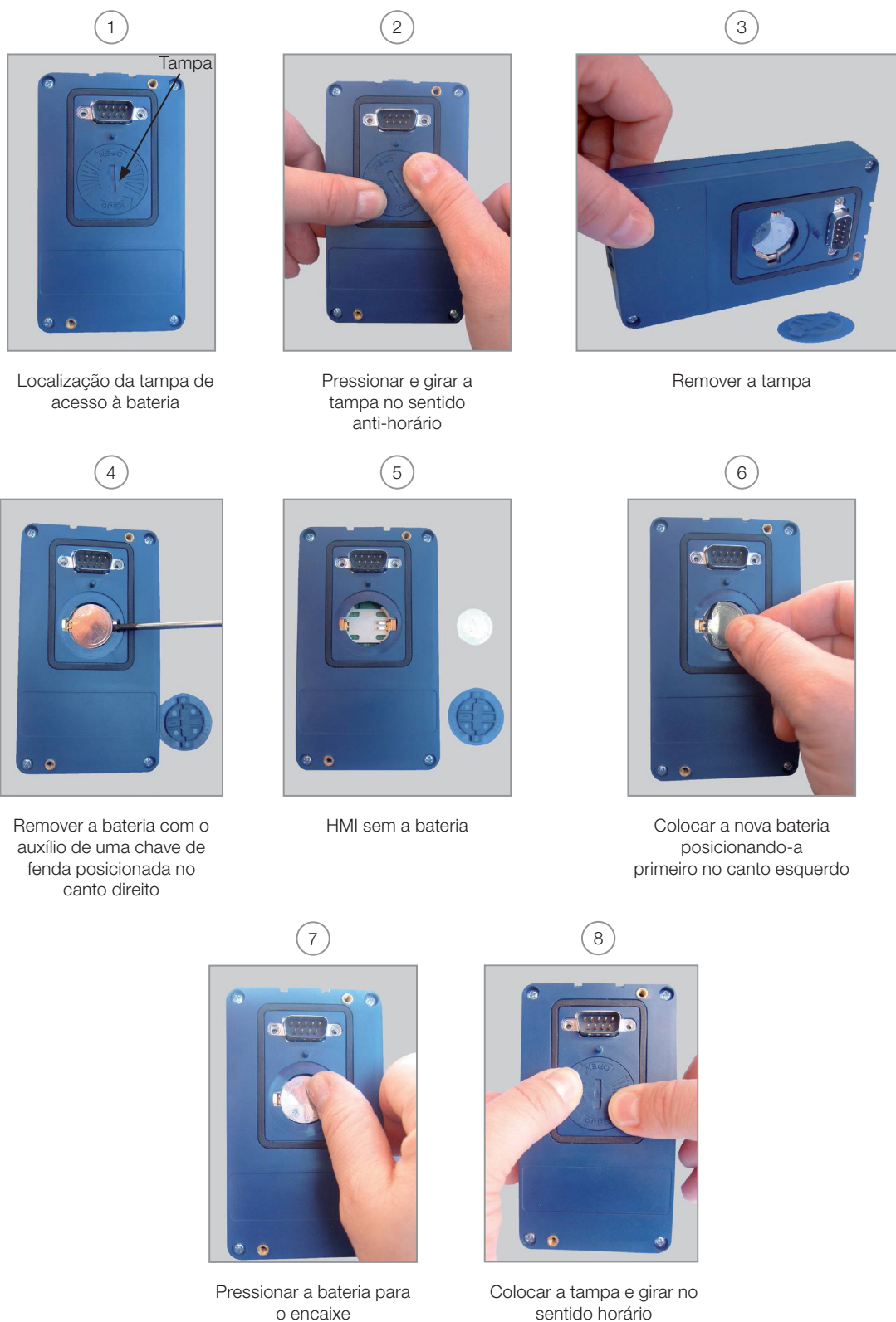
Figura 4.4: Substituição da bateria da HMI
