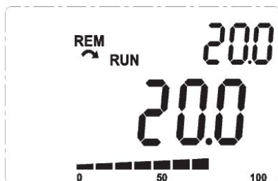
Figura 16.3: Exemplo da HMI no modo monitoração para a utilização do regulador PID
