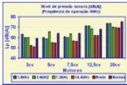
Fig.1- Ruído em função da potência dos motores e da frequência de chaveam. do inversor CFW-05.
