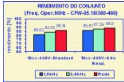
Fig. 4 - Comparativo do rendimento dos motores 10cv Standard e Alto Rend. alimentados por inversor e rede (60Hz).
