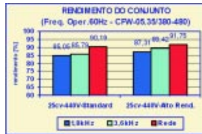
Fig. 5 - Comparativo do rendimento dos motores 25cv Standard e Alto Rend. alimentados por inversor e rede (60Hz).
