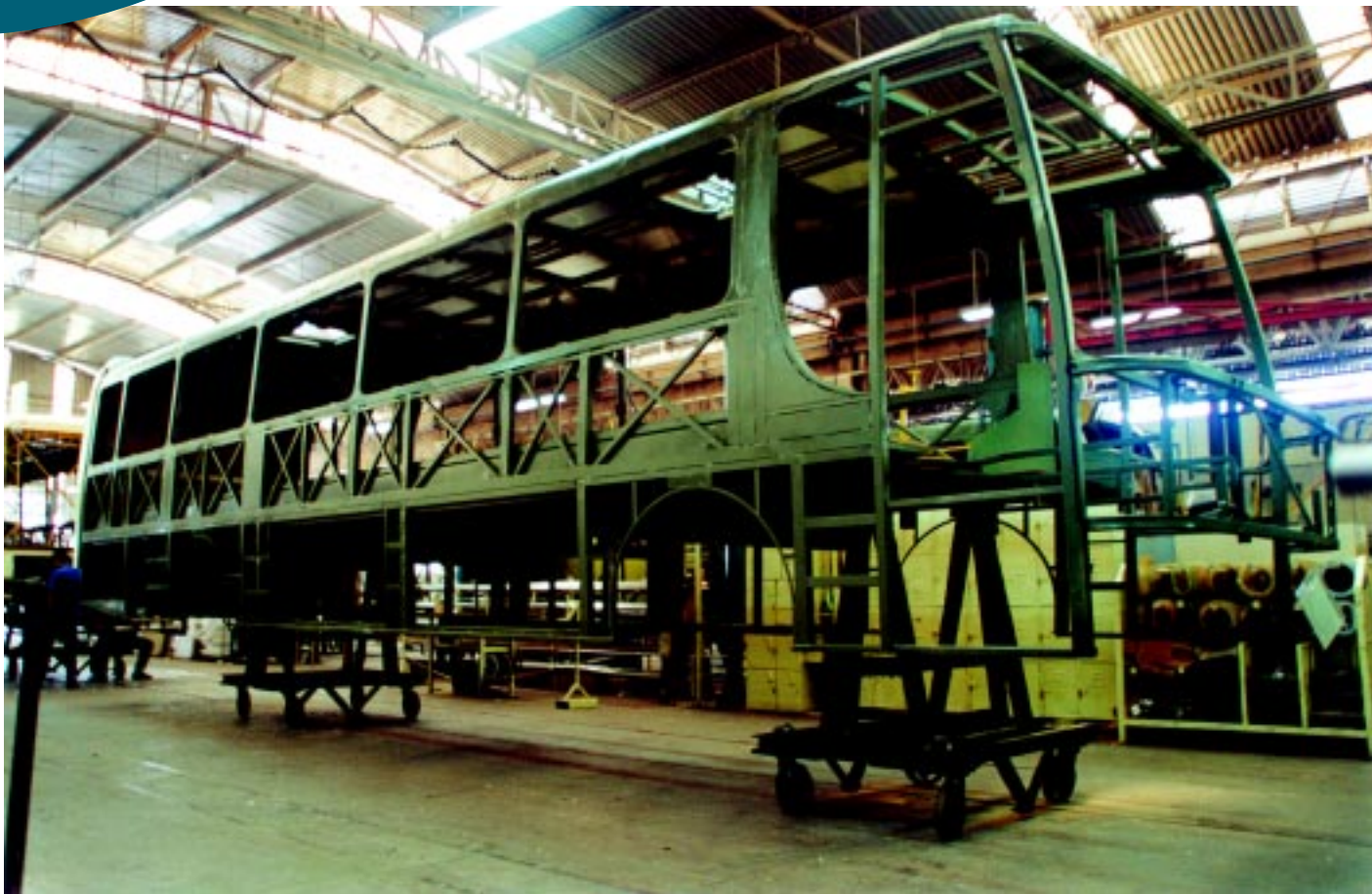
Estrutura já pintada: resistência à corrosão
