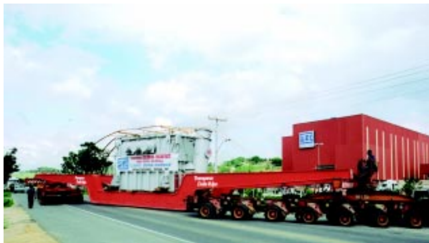
Supercarreta que leva o transformador precisa de dois motoristas
