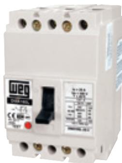
Também houve uma evolução do disjuntor DW125 para DWA160, atingindo correntes nominais até 160 A no mesmo tamanho de carcaça. Um bloco limitador acoplado ao disjuntor DWA160N amplia a capacidade de interrupção para 80 kA (380/415 V).
