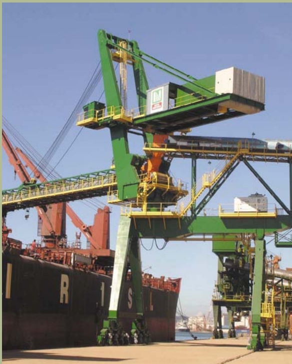
Carregador, com 54 metros e capacidade de 3 mil t/h, conta com motores, inversores e componentes WEG
