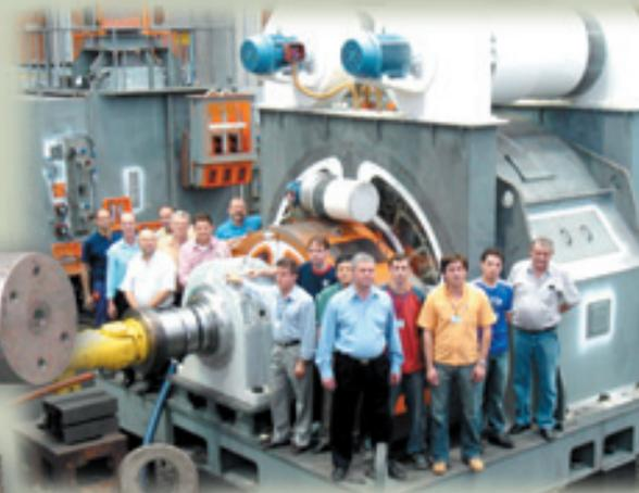
**O motor de anéis de carcaça 1.600 levou pouco mais de 90 dias para ser fabricado**
