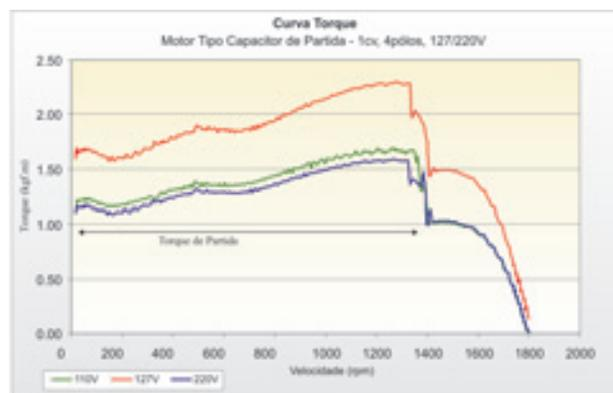
**Curva torque para motor tipo capacitor de partida 1cv, 4pólos, 127/220V**
