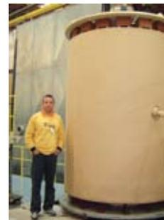
Fabricação de novos enrolamentos de alta tensão - 550 kV nas instalações da WEG
