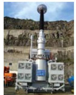
Segunda unidade sob ensaios elétricos de rotina e especiais na UHE GBM
