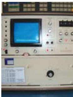
Ensaio especial - medição de descargas parciais durante 24 horas na UHE GBM
