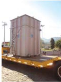
Transporte dos novos enrolamentos para a Usina em tanque especial e pressurizado
