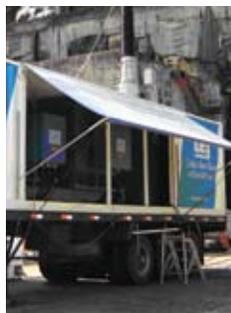
Unidade móvel de ensaios em extra-alta-tensão na UHE GBM
