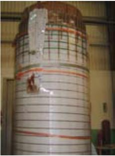
Fabricação de novos enrolamentos de baixa tensão - 16,5 kV nas instalações da WEG
