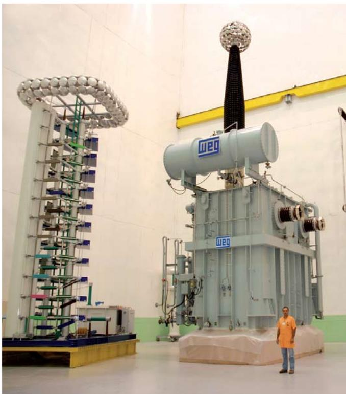
Transformador TR 256 MVA/550kV 60 Hz, irá operar do lado brasileiro da hidrelétrica
