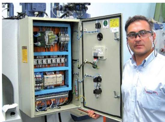
Marcelo Névoa, da Hidral-Mac, e o painel de comando elétrico que equipa a linha de prensas hidráulicas
