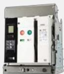
O novo ABW foi desenvolvido para a proteção de circuitos elétricos de alta potência. Com correntes nominais até 6.300 A, alta capacidade de interrupção de curto-circuito, está disponível nas versões fixo e extraível. O modelo é mais compacto, tem maior flexibilidade de montagem e maior número de proteções incorporadas como padrão.
