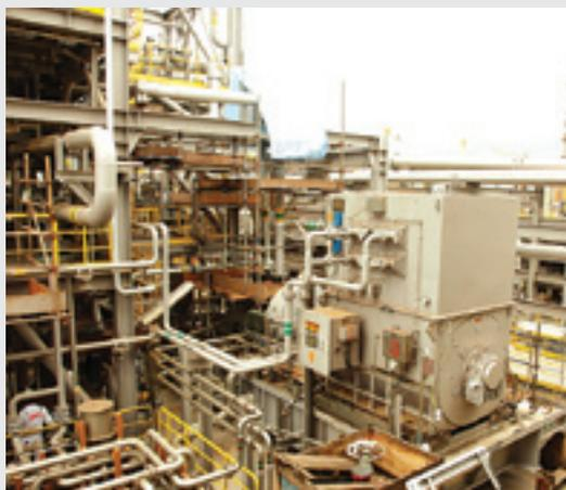
*Motor elétrico MGW900 - 6300 kW aplicado em um dos compressores de gás natural da plataforma de baixa pressão*
