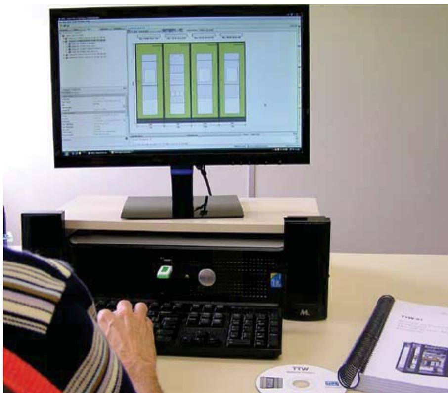
*Software de dimensionamento MakeTTW: definido o projeto elétrico e mecânico, calcula a dissipação térmica, indica a lista de itens e gera orçamento do painel*
